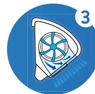
In modalità WindFree la bocchetta si chiude, ma **il fresco continua a diffondersi** in modo omogeneo senza getti d'aria diretti.
