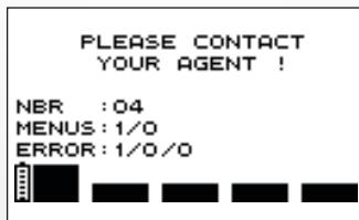
Lorsqu'un écran d'erreur s'affiche pendant l'utilisation de l'appareil, noter le numéro de l'erreur (dans l'exemple, le numéro de l'erreur est 1/0/0) et contacter le service clientèle agréé par Compex.
