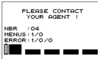
Wanneer tijdens het gebruik een foutmeldingsscherm wordt weergegeven, noteer dan het foutnummer (in het voorbeeld is het foutnummer 1/0/0) en neem contact op met het door Compex erkende klantenservicecentrum.
