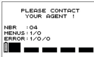
Wenn während des Gebrauchs ein Fehlerbildschirm angezeigt wird, notieren Sie die Fehlernummer (in dem Beispiel lautet die Fehlernummer 1/0/0) und wenden Sie sich an ein von Compex zugelassenes Service-Zentrum.
