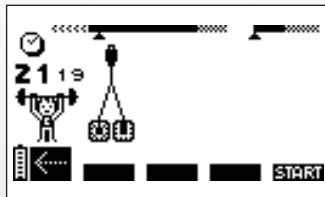
Enheten avger en ton och visar omväxlande symbolen med ett elektrodpär och en pil som pekar mot den kanal för vilken ett problem har upptäckts. I ovanstående exempel har stimulatorn upptäckt ett fel i kanal 1. Kontrollera att elektroderna är anslutna till kanalen.
