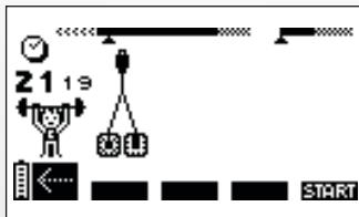
L'appareil émet une tonalité et affiche alternativement le symbole d'une paire d'électrodes et d'une flèche pointant vers le canal sur lequel un problème a été détecté. Dans l'exemple ci-dessus, le stimulateur a détecté une erreur sur le canal 1.
