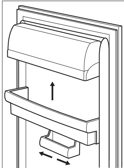
Questo modello è dotato di un contenitore a dimensione variabile per la conservazione che può essere spostato lateralmente.
