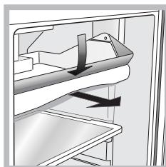
**FRESH BOX:** voor vers vlees en verse vis. Dankzij de lage temperaturen kunt u levensmiddelen in dit vak langere tijd (tot een week) bewaren, - dit is het koudste gedeelte van de koelkast. Dankzij het doorzichtige deksel wordt het voedsel beschermd tegen oxidatie- en verkleuringverschijnselen. Het kan ook worden gebruikt voor "koude gerechten".
