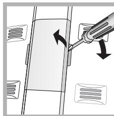
Om het lampje van het koelgedeelte te vervangen, dient u eerst de stekker uit het stopcontact te halen.
