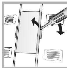
Zum Austausch der Lampe der Kühlzonenbeleuchtung muss der Netzstecker aus der Steckdose gezogen werden. Öffnen Sie die Lampenabdeckung (*siehe Abbildung*) und ersetzen Sie die Lampe durch eine neue gleicher Leistung und Bauform (nicht höher als 10 Watt).
