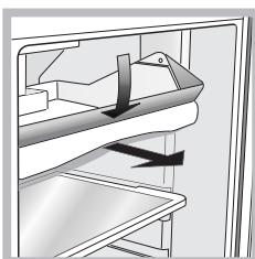
**FRESH BOX:** pour viandes et poissons frais. Ce compartiment sert à prolonger la durée de conservation jusqu'à une semaine, grâce à sa température très basse – la plus froide du réfrigérateur – et à son volet transparent qui protège contre les phénomènes d'oxydation et de noircissement. Il peut aussi être utilisé pour conserver des "plats froids".
