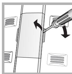
Per sostituire la lampadina di illuminazione del vano frigorifero, staccare la spina dalla presa di corrente.
