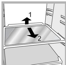
**DRAAGPLATEAUS:** deze kunnen dankzij de speciale geleiders worden verwijderd of in hoogte geregeld (zie afbeelding), voor het invoeren van grote verpakkingen of etenswaren. Het is niet noodzakelijk het draagplateau volledig te verwijderen om de hoogte ervan te regelen.
