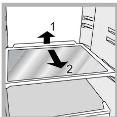
**RIPIANI:** sono estraibili e regolabili in altezza grazie alle apposite guide (vedi figura), per l'inserimento di contenitori o alimenti di notevole dimensione. Per regolare l'altezza non è necessario estrarre completamente il ripiano.
