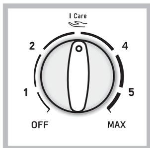
Le réglage de la température à l'intérieur du compartiment congélateur est automatique en fonction de la position du bouton du thermostat.
