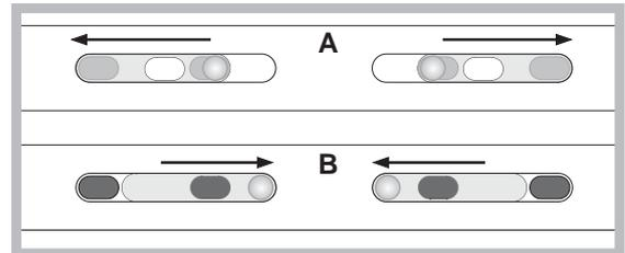
Indicateur de **TEMPERATURE**: pour repérer la zone la plus froide à l'intérieur du réfrigérateur.
