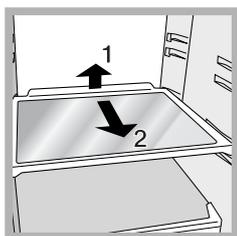
Son extraíbles y su altura es regulable gracias a las guías especiales (ver *la figura*), se utilizan para introducir recipientes o alimentos de gran tamaño. Para regular la altura no es necesario extraer las bandejas completamente.
