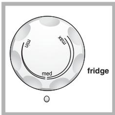
Le réglage de la température à l'intérieur du compartiment réfrigérateur est automatique en fonction de la position du bouton du thermostat.
