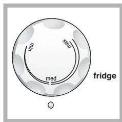
La temperatura all'interno del reparto frigorifero si regola automaticamente in base alla posizione della manopola del termostato.
