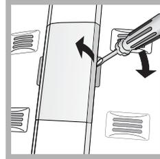
Öffnen Sie die Lampenabdeckung. (*siehe Abbildung*) und ersetzen Sie die Lampe durch eine neue gleicher Leistung und Bauform (nicht höher als 10 Watt).
