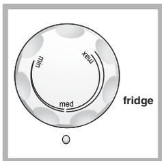
Die Innentemperatur des Kühlschranks wird automatisch geregelt, je nach Einstellung des Thermostatschalters.
