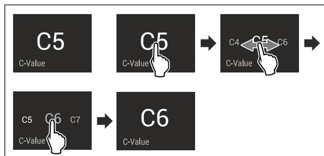
Fig. 28 Immagine a titolo di esempio: Passaggio da C5 a C6.
