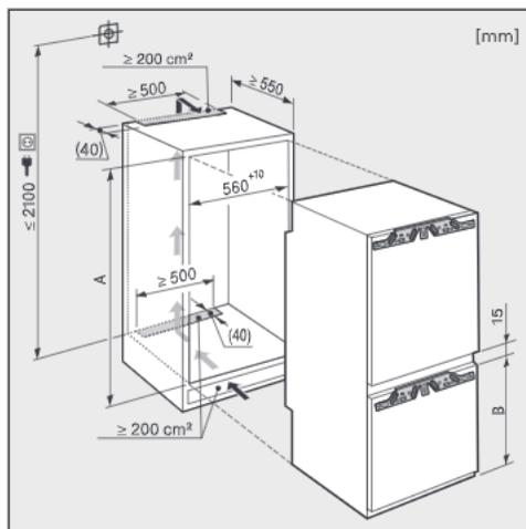
Prima di incassare l'apparecchio, controllare che il mobile abbia le dimensioni richieste. Le dimensioni dell'apertura di aerazione e sfiato dovranno essere adeguate per garantire il perfetto funzionamento dell'apparecchio.
