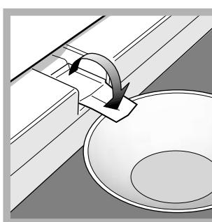
5. Alcuni apparecchi sono dotati del SISTEMA DRAIN per convogliare l'acqua all'esterno: inserire il raschietto in dotazione nell'apposita fessura posta in basso e lasciare che l'acqua defluisca in un contenitore (*vedi figura*)
