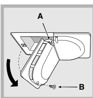
Accedere alla lampada (A) svitando la vite di fissaggio (B) posizionata nella parte posteriore del comprilampada, come indicato (*vedi figura*). Sostituirla con una analoga, di potenza non superiore a 15 W.
