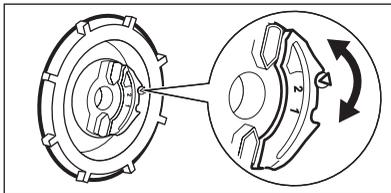
Ruotare il selettore della durezza dell'acqua nella posizione 1 o 2.
