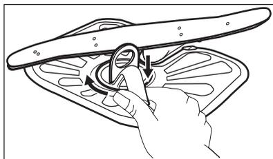
6. Montare il filtro (A) e posizionarlo all'interno del filtro (B). Ruotarlo in senso orario finché non si blocca in posizione.
