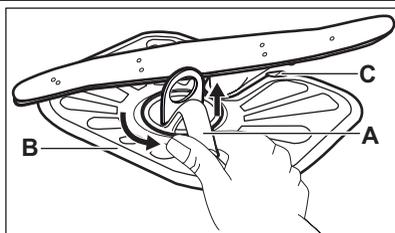
1. Ruotare il filtro (A) in senso antiorario e rimuoverlo.
