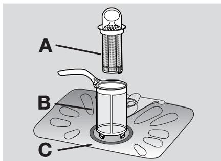
1. Per sbloccare il gruppo di filtraggio, ruotare la maniglia sul microfiltro (B) di circa 1/4 di giro in senso antiorario.
