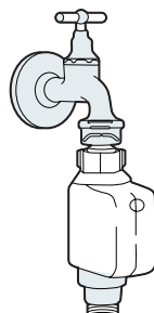
tubo di alimentazione di sicurezza
