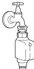
tubo di alimentazione di sicurezza
