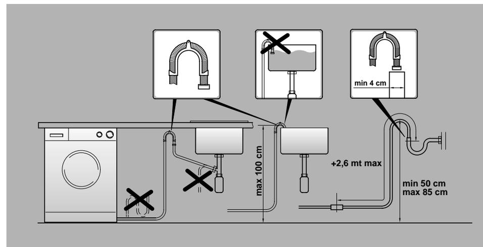
**Attenzione: dopo ogni lavaggio è consigliabile chiudere il rubinetto di carico per isolare la lavatrice dal circuito idraulico.**
