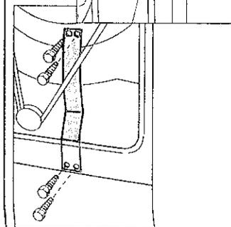
Rimonti il pannello posteriore incastrando la zona superiore, avviti le 2 viti tolte e le 4 viti contenute nella busta istruzioni.
