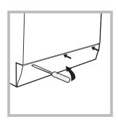
1. rimuovere il pannello di copertura sul lato anteriore della lavasciuga con l'ausilio di un giravite (vedi figura);
