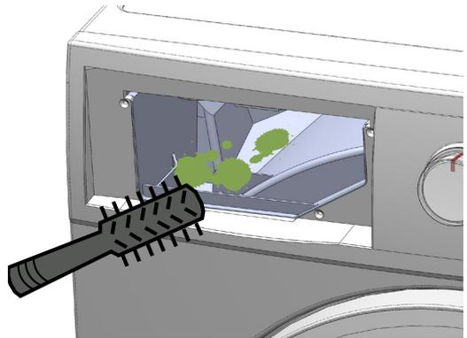
Qualora il foro di scarico della vaschetta fosse ostruita da detersivo o da corpi estranei, è consigliabile rimuovere l'ostacolo avendo cura di non spingere l'ostruzione a fondo per evitare di intasare il circuito interno. Ricordiamo che il detersivo si rimuove con facilità se trattato con acqua calda.
