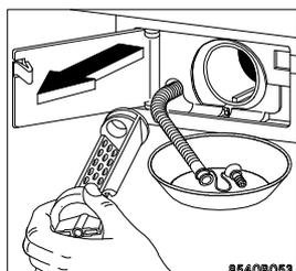
3. Svitare il coperchio in senso antiorario e toglietelo. Pulite il filtro con acqua pulita. Inserite il filtro, controllando che i bordi siano bene inseriti nelle guide previste per tale scopo. Riavvitare il coperchio del filtro. Rimontate il canaletto di scarico e chiudete lo sportello.
