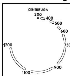
Mediante il selettore della velocità di centrifuga potrete scegliere la velocità della centrifugazione finale da 300 fino a 1200 giri/min. Per il sintetico, la biancheria delicata e la lana, la velocità della centrifugazione è in principio limitato a 850 giri/min.
