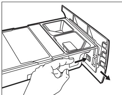
9. Verificare che tutti i residui di detersivo vengano rimossi dalla parte superiore e inferiore dell'alloggiamento del cassetto. Servirsi di una spazzolino per pulire l'alloggiamento.
