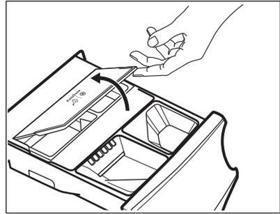
3. Versare delicatamente il detersivo liquido nel serbatoio del detersivo AutoDose . Riempire fino al livello massimo indicato **MAX**.
