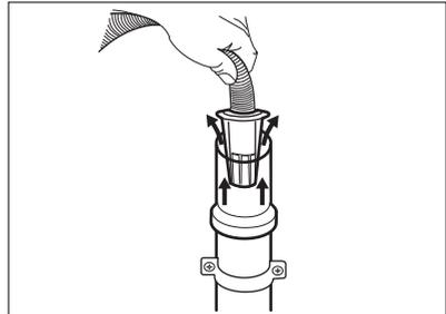
4. A un tubo verticale dotato di fori di ventilazione - Inserire il tubo di scarico direttamente in una condotta di scarico. Fare riferimento all'immagine.
