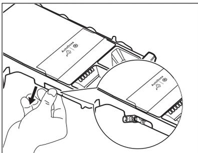
4. Premere il blocco sul retro conformemente a quanto indicato nell'immagine e sollevare il coperchio superiore per eseguire la rimozione.
