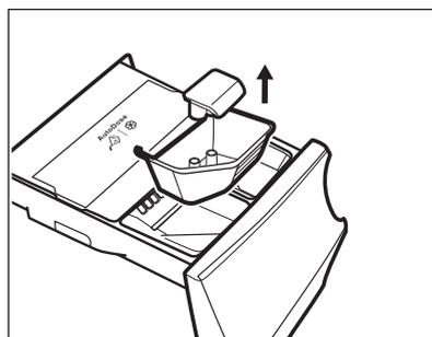
3. Aprire i tappi di scarico di ogni serbatoio e svuotarli nel lavandino.
