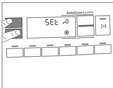
5. Sfiare i relativi tasti carburante per disattivare e attivare la funzione. Sul display compare OFF quando un serbatoio viene disattivato oppure mostra la spia del serbatoio quando è attivato.
