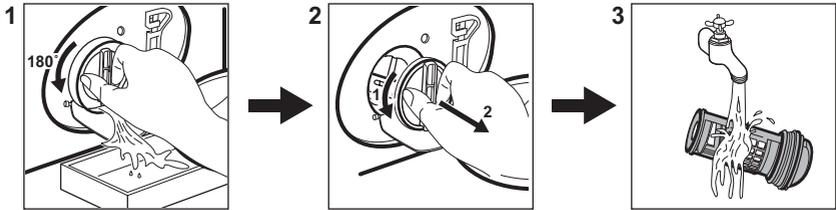
Pulire il filtro a intervalli regolati, e in particolare modo se il codice allarme **E2** viene visualizzato sul display.
