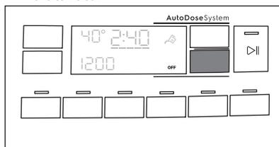
6. Per impostare il dosaggio di base sfiorare i relativi pulsanti serbatoio fino a che sul display non compaiono un dosaggio per bucato predefinito e due frecce sulla parte inferiore del display. Sfiare ripetutamente il
