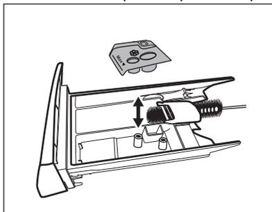
3. Verificare che tutti i residui di detersivo vengano rimossi dalla parte superiore e inferiore dell'incasso. Servirsi di una spazzola piccola per pulire l'incasso.
