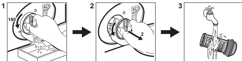
Pulire il filtro a intervalli regolati, e in particolar modo se il codice allarme **E20** viene visualizzato sul display.
