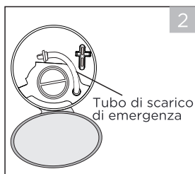
2 Estrarre il tubo di scarico di emergenza e togliere il tappo del tubo
