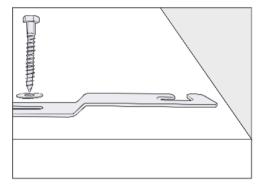
Montare la staffa di fissaggio con le viti esagonali e le rondelle.
