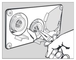
Sfilare il filtro afferrandolo alla nervatura con una pinza appuntita e pulirlo. Rimontarlo seguendo la procedura in ordine inverso.
