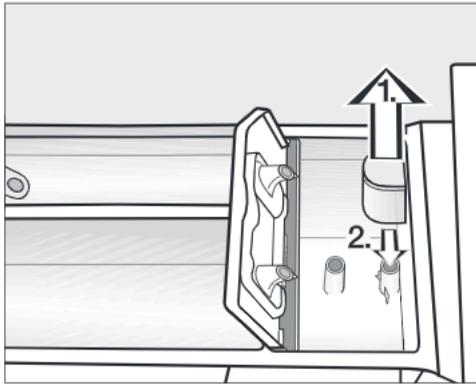
1. Sfilare il dispositivo di aspirazione dalla vaschetta ☼ e pulirlo sotto acqua calda corrente. Pulire anche il tubicino sul quale il dispositivo si innesta.
