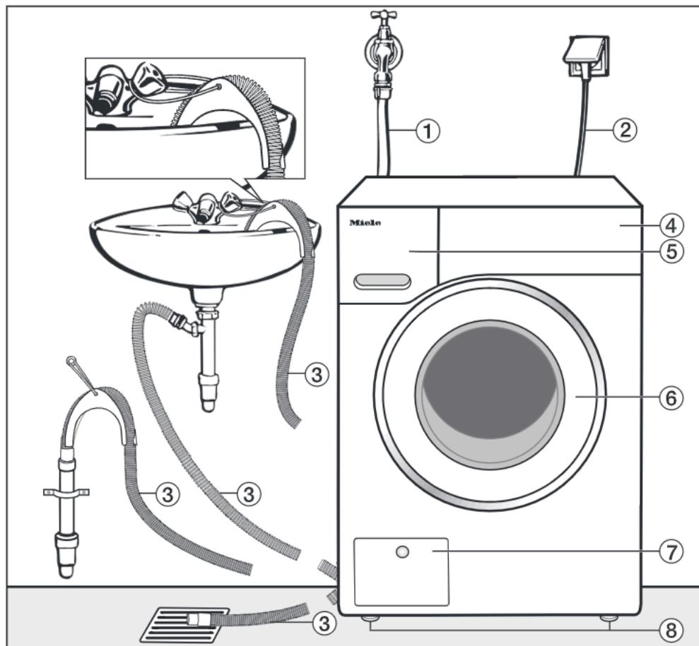
① Tubo di afflusso idrico (resistente fino a 7.000 kPa)
