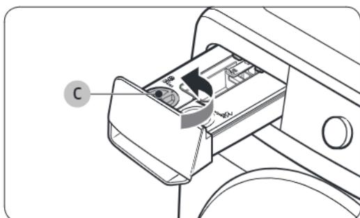
4. Ruotare il **coperchio di erogazione automatica dell'ammorbidente (C)** in senso antiorario per aprirlo.
