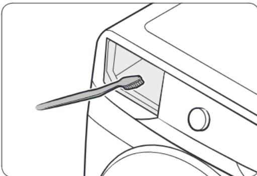
3. Pulire l'interno del cassetto usando una spazzola così da rimuovere eventuali residui di detersivo e di calcare.
