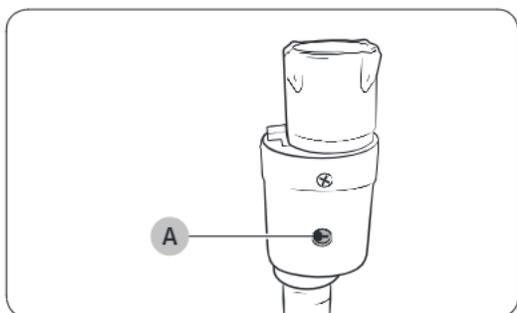
Il tubo Aqua stop avvisa l'utente di possibili rischi di perdite di acqua. Rileva il flusso dell'acqua e visualizza una tacca rossa al centro dell'**indicatore (A)** in caso di perdita.
