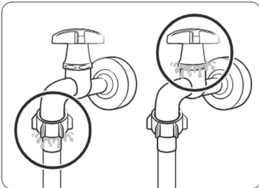
1. Collegare il tubo al rubinetto dell'acqua quindi ruotare il connettore per serrarlo.
