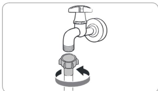
1. Collegare il tubo dell'acqua al rubinetto dell'acqua, quindi ruotare il connettore in senso orario come illustrato.
