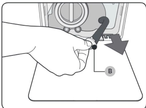
3. Appoggiare un contenitore ampio e vuoto intorno al tappo e stendere il tubo di scarico di emergenza nel contenitore trattenendo il **tappo del tubo (B)**.
