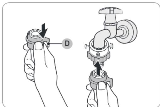
6. Tirando verso il basso la **componente (D)** sul tubo dell'acqua, collegare il tubo dell'acqua all'adattatore. Quindi rilasciare la **parte (D)**. Quando il tubo si innesta nell'adattatore si avverte un clic.
