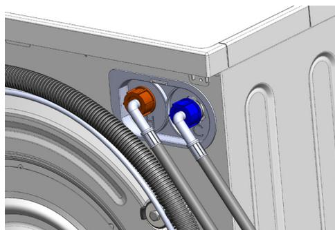
Verificare che la temperatura dell'acqua calda dell'impianto domestico non superi i 55°C per evitare il danneggiamento della biancheria e della lavabiancheria. Per il tubo di carico utilizzare solo quello fornito in dotazione.
