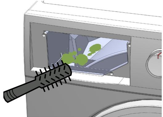
Qualora il foro di scarico della vaschetta fosse ostruito da detersivo o da corpi estranei, è consigliabile rimuovere l'ostacolo avendo cura di non spingere l'ostruzione a fondo per evitare di intasare il circuito interno. Ricordiamo che il detersivo si rimuove con facilità se trattato con acqua calda.
