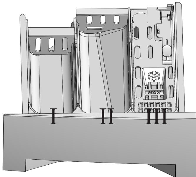
**I** - Comparto per detersivo utilizzato nella fase di prelavaggio o di ammollo.
