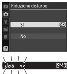
Se selezionate **No**, la riduzione di disturbo verrà eseguita solo ad alte sensibilità ISO; la quantità di riduzione di disturbo è inferiore rispetto a quella eseguita quando si seleziona **Si**.
