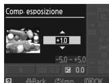
L'esposizione normale può essere ripristinata impostando la compensazione dell'esposizione su  $\pm 0$ . La compensazione dell'esposizione non viene ripristinata quando la fotocamera viene spenta.
