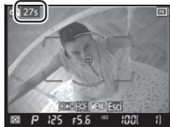
Per evitare danni alla circuitazione interna della fotocamera, la ripresa live view termina automaticamente prima che la fotocamera si surriscaldi. Un display indicante il conto alla rovescia verrà visualizzato nel monitor 30 sec. prima del termine della ripresa. Ad alte temperature il display può apparire appena viene selezionato il modo visione live view.
