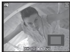
Quando si ingrandisce la vista dell'obiettivo, viene visualizzata una finestra di navigazione nell'angolo in basso a destra del display. Utilizzate il multiselettore per scorrere le foto nelle cornici dell'area AF.
