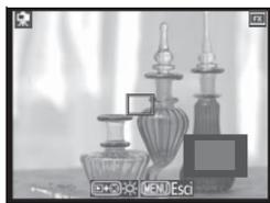
Quando si ingrandisce la vista dell'obiettivo, viene visualizzata una finestra di navigazione nell'angolo in basso a destra del display. Potete utilizzare il multiselettore per scorrere le aree dell'inquadratura non visibili nel monitor.
