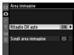
selezionata utilizzando l'opzione [Area immagine] nel menu di ripresa. Se si utilizza l'impostazione predefinita [Ritaglio DX auto], la fotocamera ritaglia automaticamente le foto con un angolo d'immagine DX se è montato un obiettivo formato DX. Utilizzate l'opzione [Scegli area immagine] per selezionare un angolo d'immagine di 35 mm o per ritagliare le foto con un angolo d'immagine nel formato DX oppure con un rapporto 5 : 4.
