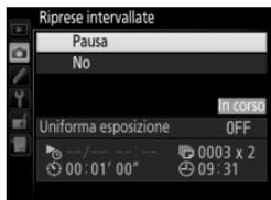
È possibile riprodurre le immagini e regolare liberamente le impostazioni di ripresa e di menu durante l'esecuzione delle foto intervallate. Il monitor si spegne automaticamente circa quattro secondi prima di ogni intervallo.
