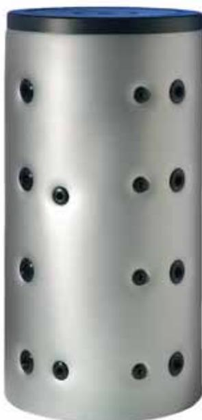
Questo serbatoio è realizzato per fornire un accumulo d'acqua di riscaldamento in appoggio a fonti derivate come la caldaia a gas (o gasolio), la caldaia a legna, la termo cucina, caminetti ed altre fonti di energia derivate. Questo modello, disponibile in più versioni (da 300 a 2000 Lt) è garantito per pressioni di esercizio di 3 bar. Il serbatoio in lamiera di grosso spessore è internamente al grezzo e trattato esternamente con vernice antiruggine.
