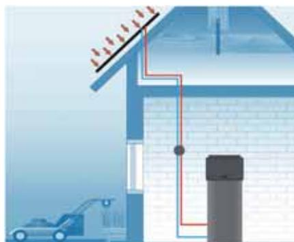
Esempio di collegamento fra un collettore solare e uno scaldacqua BSBPC.
