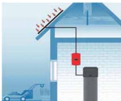
Esempio di installazione fra un pannello fotovoltaico e uno scaldacqua BSBPC.
