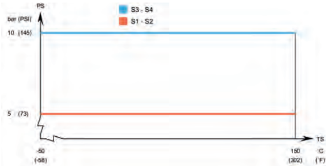
CBH16 - Diagramma relativo a temperatura/pressione secondo omologazione PED
