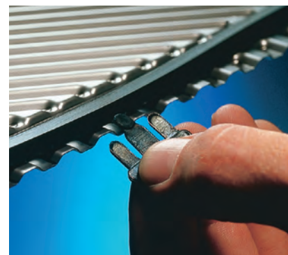
Sistema Clip-on (a incastro) senza colla
