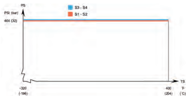
CB400 - Diagramma relativo a temperatura/pressione secondo omologazione CRN*
