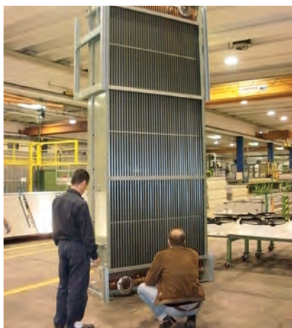
I raffreddatori per olio AlfaBlue vengono prodotti nella fabbrica Alfa Laval di scambiatori di calore ad aria in Italia.
