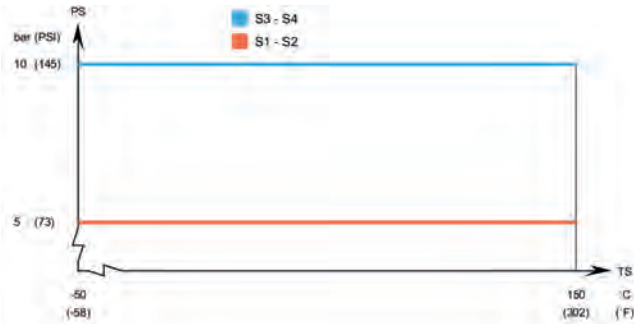
CBH18 - Diagramma H relativo a temperatura/pressione secondo omologazione PED
