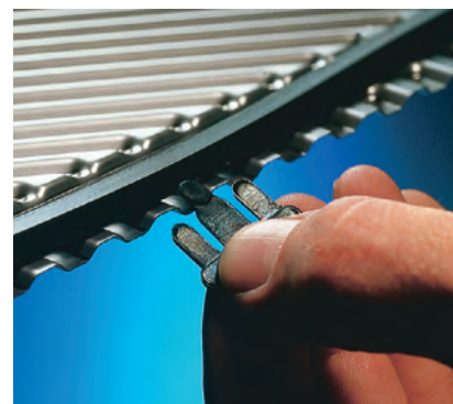
Sistema Clip-on (a incastro) senza colla
