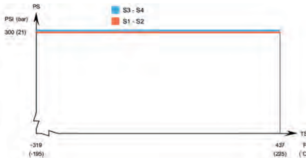
AlfaNova 14 - Diagramma relativo a temperatura/pressione secondo omologazione CRN
