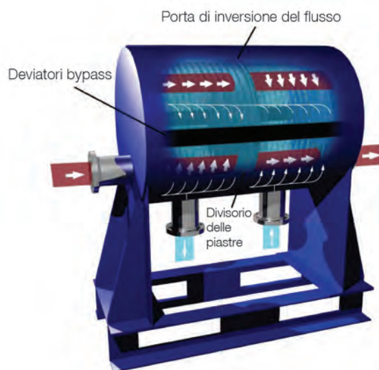
Schema di flusso di un AlfaDisc a passaggio multiplo.
