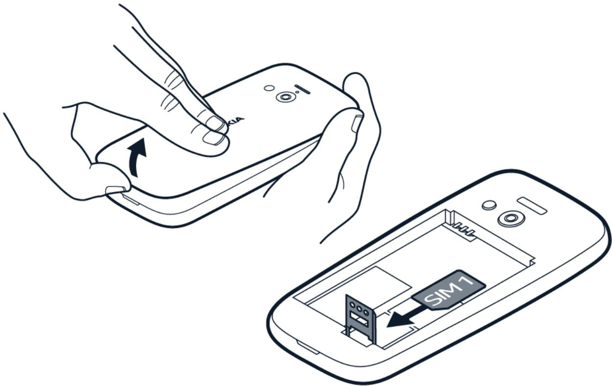
1. Posizionare l'unghia nello slot piccolo nella parte inferiore del telefono, sollevare e rimuovere la cover.
