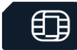
**Importante:** questo dispositivo è stato progettato per essere utilizzato solo con una carta mini-SIM (v. figura). L'utilizzo di carte SIM incompatibili potrebbe danneggiare il dispositivo o la carta, nonché i dati memorizzati su di essa.
