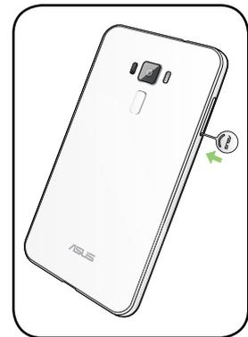
3. Inserite la Micro-SIM/Nano-SIM nell'alloggiamento Micro-SIM/Nano-SIM.
