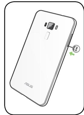
3. Inserite la microSD nello slot Nano-SIM/microSD.
