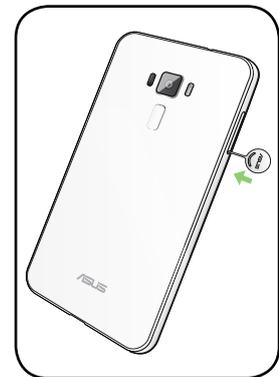
3. Estraete la scheda Micro-SIM/Nano-SIM dallo slot Micro-SIM, Nano-SIM/microSD.
