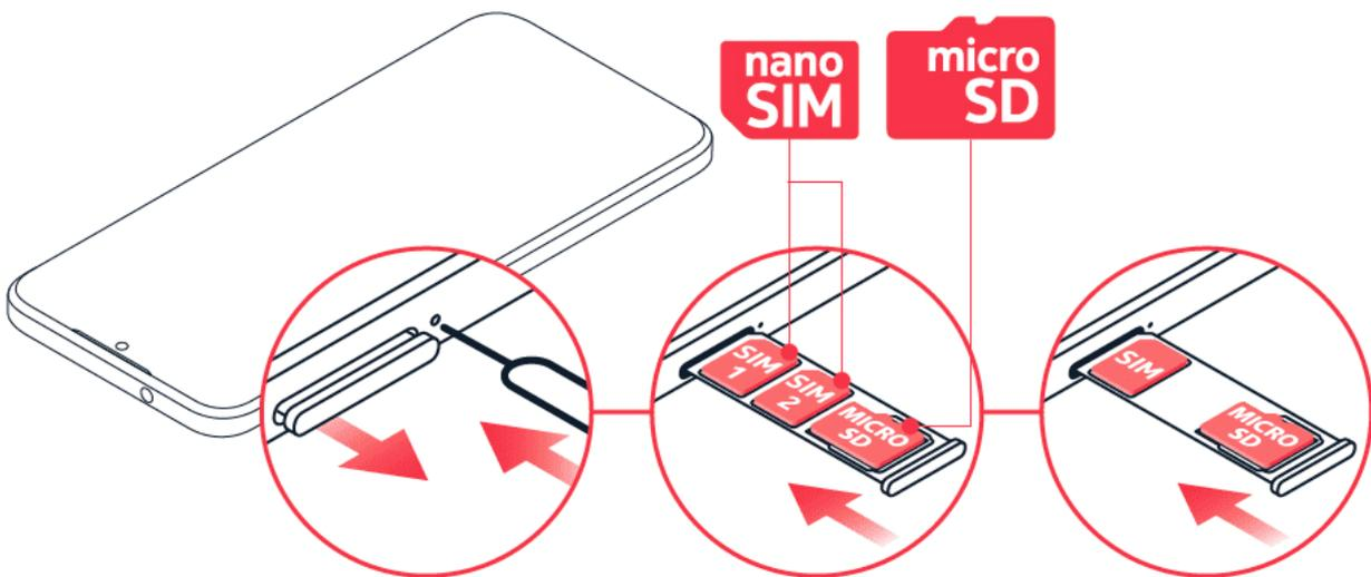
1. Aprire l'alloggiamento della SIM e della scheda di memoria: infilare la puntina per l'apertura nel foro dell'alloggiamento ed estrarre l'alloggiamento.
