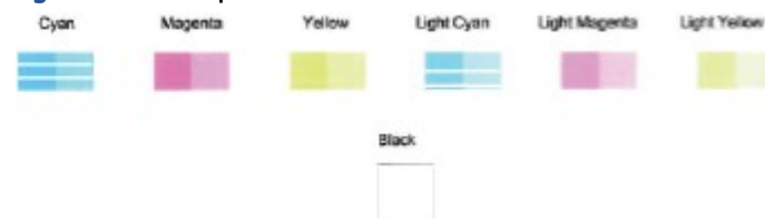
Figura 9-2 Esempi di blocchi di colore con difetti
