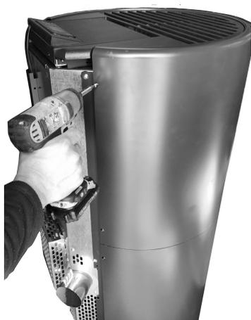
**Fig. 66 - Rimozione viti posteriori**
