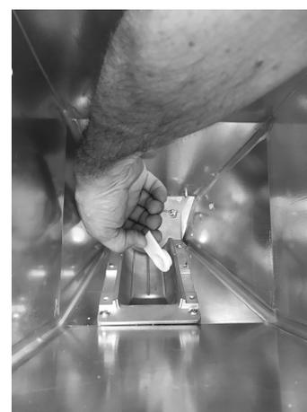
**Fig. 81 - Rimozione cuscinetto**
