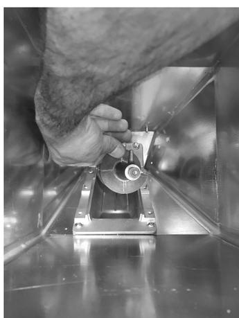
**Fig. 80 - Rimozione spirale**
