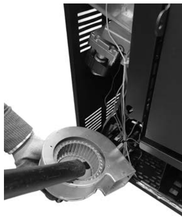
Fig. 71 - Pulizia ventilatore ambiente
