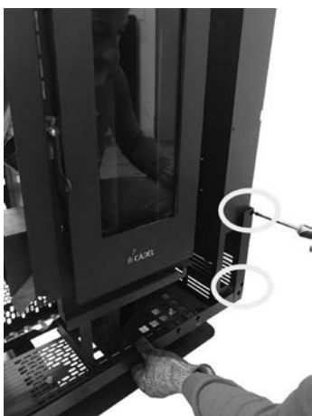
Fig. 28 - Fissaggio staffa inferiore
