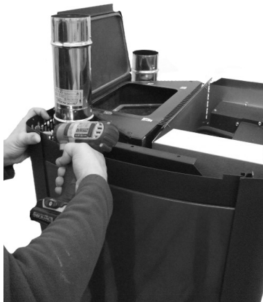
Fig. 91 - Rimozione profili curvi superiori
