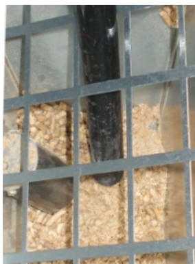
Fig. 90 - Pulizia serbatoio e coclea
