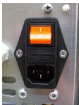
Fig. 65 - Presa elettrica con interruttore generale
