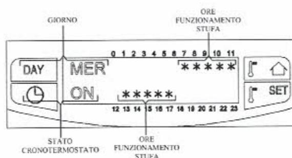
Fig. 9 Programmazione cronotermostato
