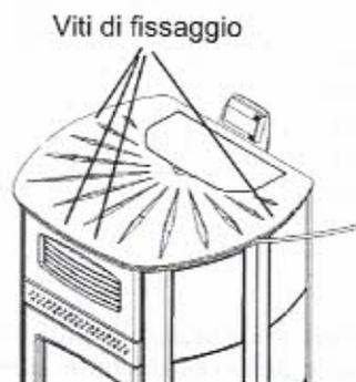
Fig.14a Rimozione viti fissaggio
