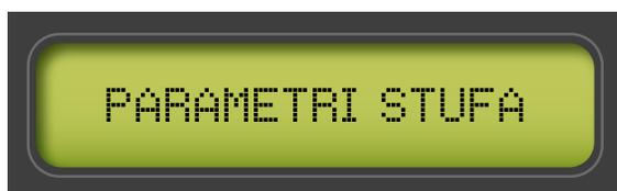
Premendo SET si entra per modificare i parametri principali della stufa quali carico pellets, velocità aspiratore fumi, ventilatore aria ambiente e correzione della temperatura ambiente. Mediante i tasti TEMP+ e TEMP- è possibile modificare in percentuale le impostazioni della stufa per correggere il funzionamento in base al pellets utilizzato. Premere poi SET per confermare il
