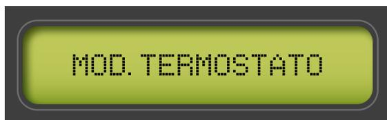
Premendo SET si entra a modificare la modalità di funzionamento per il controllo di temperatura o accensione e spegnimento automatizzato.
