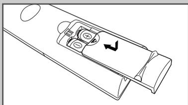
*È necessario inserire o sostituire le batterie nel telecomando*
