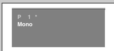
Se la ricezione è chiara, non è necessaria una sintonia fine del canale, poiché questa viene eseguita automaticamente durante l'operazione di ricerca e memorizzazione. Se invece il segnale è debole o disturbato, è necessario eseguire manualmente una sintonia fine del canale.
