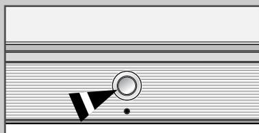
*Inserire la spina di alimentazione sul pannello posteriore del televisore.*
