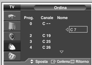
*Questa operazione consente di modificare i numeri dei programmi dei canali memorizzati. L'operazione può rendersi necessaria dopo aver utilizzato la sintonia automatica.*
