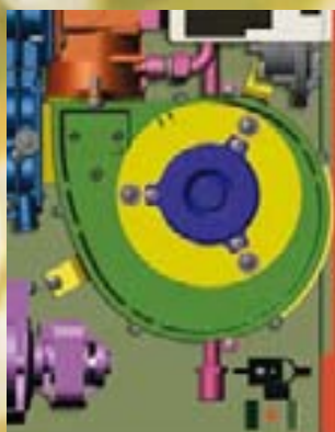
Motore del ventilatore di aspirazione aria a velocità variabile a controllo intelligente
