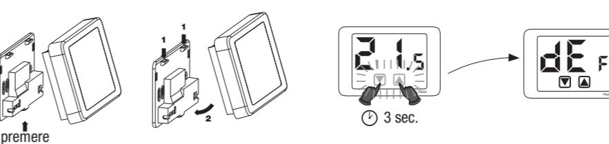
Sganciare e riagganciare il termostato dalla base (modelli a batterie) oppure togliere e ridare alimentazione (modelli a 230V). Tenere premuti i tasti per almeno 3 secondi durante il lampeggio della tastiera.
