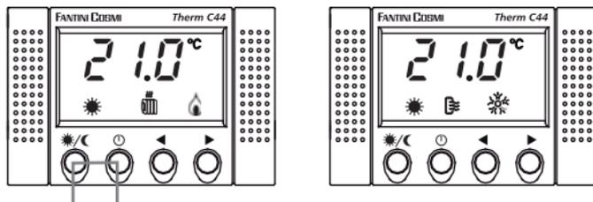
premere contemporaneamente entrambi i tasti per selezionare o il funzionamento ESTATE (raffrescamento) o INVERNO (riscaldamento).
