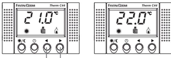
una volta impostato il modo di funzionamento desiderato ☀ ☾ ⏻ premere uno dei due tasti per impostare (incrementare ►◀ diminuire ◀►) la temperatura: ECONOMY / TMIN 2 ÷ 40 °C
