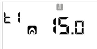
3. Viene visualizzato il valore della temperatura T1 lampeggiante. Modificare il valore con i tasti ▲ e ▼ e premere il tasto ↵ per passare alla modifica di T2.
