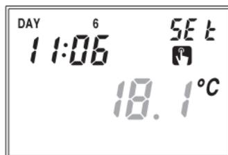
Premendo il tasto “✓” o dopo 45 secondi dall'ultima operazione, sul campo (16) ricompare il valore della temperatura ambiente, mentre sul campo (15) ricompare il valore della temperatura esterna (se la sonda è collegata).
