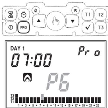
Con i tasti **T1**, **T2** e **T3** è possibile modificare la temperatura selezionata per quell'ora e, allo stesso tempo, passare all'ora successiva. Utilizzando i tasti “▲” e “▼” è possibile spostarsi di ora in ora senza modificare la temperatura impostata.
