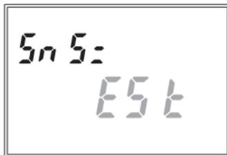
Scegliere tramite i tasti **“▲”** e **“▼”** **“Int”** se si vuole utilizzare la sonda interna oppure **“Est”** se si vuole utilizzare la sonda esterna e premere **“✓”** per confermare la scelta.
