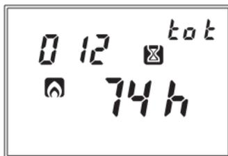
Sono presenti due totalizzatori indipendenti per il funzionamento invernale e per il funzionamento estivo. Il valore massimo memorizzabile è di 65535 ore. Per azzerare il contatore, premere il tasto **"⌚"** per circa 3 secondi quando ci si trova nel menù visualizzazione del contatore.
