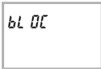
Per sbloccare la tastiera, premere nuovamente i tasti **T1**, **T2** e **T3** per 3 secondi e immettere tramite i tasti “▲” e “▼” la password di protezione.
