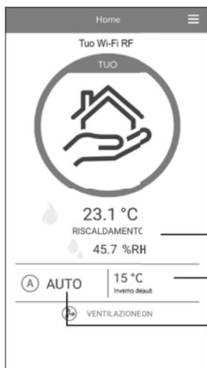
indica la temperatura e umidità misurate (23,1°C - 45,7% RH), il modo di funzionamento (Riscaldamento), lo stato dell'impianto:
