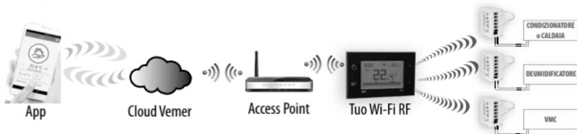
Il dispositivo si connette al cloud Vemer per verificare se ci sono modifiche alla configurazione e alla programmazione creata utilizzando la app, e in caso affermativo, regola la temperatura e/o l'umidità secondo la nuova configurazione. Questa operazione avviene all'incirca una volta al minuto.
